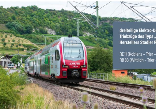
dreiteilige Elektro-Doppelstock-Triebzüge des Typs „KISS“ des Herstellers Stadler Rail
