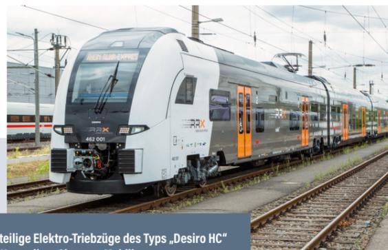
vierteilige Elektro-Triebzüge des Typs „Desiro HC“ des Herstellers Siemens Mobility
